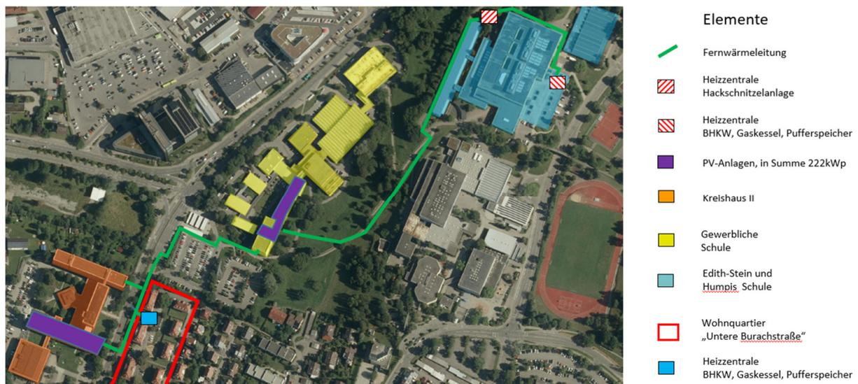
Die neue Heizenergiezentrale entsteht in Verlängerung des Langbaus des Berufsschulzentrum. In dieser neuen Energiezentrale „Neubau“ wird eine Holz hackschnitzel-Kesselanlage ausgeführt werden. In der Berufsschule werden in dem bestehenden Heizraum zusätzlich zwei BHKW-Anlagen und zwei Gaskesselanlagen vorgesehen.
